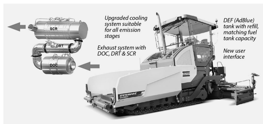
Die mit Tier 4 final Motoren ausgerüsteten großen Kettenfertiger von Atlas Copco tragen zu Kraftstoffeinsparungen bei. Abb.: Atlas Copco
